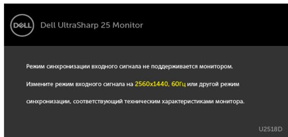
Это означает, что монитор не может произвести синхронизацию с получаемым от компьютера сигналом. Информацию о диапазонах частоты строк и кадров, применимых к данному монитору, см. в разделе [Технические характеристики монитора](#). Рекомендуется разрешение 2560 x 1440.
