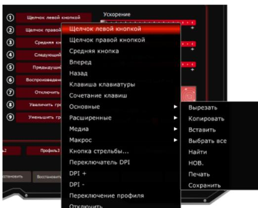
**Сочетание клавиш...** – при выборе этой функции открывается окно настройки сочетания любых клавиш клавиатуры (например, Shift+W) на кнопку мыши. Чтобы кнопка мыши начала эмулировать кнопку клавиатуры, нажмите нужное сочетание клавиш клавиатуры и затем «OK».
