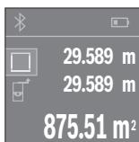
Prvá nameraná hodnota sa zobrazí hore na displeji. Po skončení druhého merania sa automaticky vypočíta a zobrazí plocha. Konečný výsledok sa zobrazí dolu na displeji, jednotlivé namerané hodnoty nad ním.
