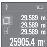
По завршување на третото мерење волуменот автоматски ќе се пресмета и прикаже. Крајниот резултат стои долу на екранот, а поединечните измерени вредности над него.
