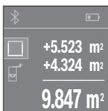
Apăsați tasta de măsurare **4**, pentru a începe o nouă măsurătoare de suprafață. Determinați suprafața conform paragrafului „Măsurarea suprafețelor”, vezi pagina 120. și pentru a finaliza adunarea, apăsați tasta de măsurare **4**. Petru adunarea altor valori măsurate, apăsați din nou tasta **1 [+]** s.a.m.d.
