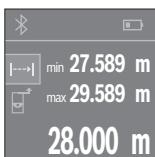
Za aktiviranje postupka mjerjenja pritisnite tipku za mjerjenje **4**. Mjerni alat pomiciće sve dok se željena vrijednost udaljenosti ne prikaže dolje na displeju.
