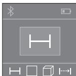
След включване измервателният уред се намира в режим за измерване на дължини. Можете да превключите на други режими за измерване чрез неколократно натискане на бутона **2** (вижте „Режими на измерване“, страница 134). След избор на функция за измерване с бутона **4** се включва лазерният лъч.
