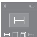
Nakon uključivanja mjerni alat se nalazi u funkciji mjerjenja dužina. Druge funkcije mjerjenja možete podešiti višekratnim pritiskom na tipku **2** (vidi »Funkcije mjerjenja«, stranica 191).
