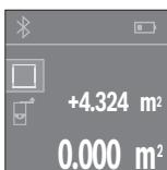
Wcisnąć przycisk **1** [+]. Obliczona powierzchnia wyświetliona zostanie pośrodku wyświetlacza.
