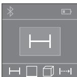
После включения измерительный инструмент находится в режиме измерения длины. Другие режимы измерения можно настроить многочтным нажатием на кнопку **2** (см. «Режимы измерений», стр. 72).
