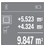
Wcisnąć przycisk pomiarowy **4**, aby rozpocząć kolejny pomiar powierzchni. Wyznaczyć powierzchnię zgodnie z rozdziałem »Pomiar powierzchni«, zob. str. 13. Aby zakończyć dodawanie, należy wcisnąć przycisk **4**. Aby dodać kolejne wartości pomiarowe, należy ponownie wcisnąć przycisk **1** [+] itp.
