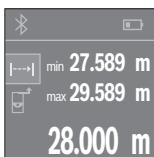
За стартиране на измерването натиснете бутона **4**. Премествайте измервателния уред, докато в долната част на дисплея се изпише желаното разстояние.
