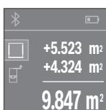
Pritisnite tipku za mjerenje **4** za započinjanje mjerenja druge površine. Utvrđite površinu sukladno odlomku »Mjerenje površina«, vidi stranicu 191. Kako biste završili zbrajanje, pritisnite tipku za mjerenje **4**. Za zbrajanje ostalih izmijerenih vrijednosti ponovno pritisnite tipku **1 [+]** itd.
