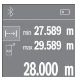
Po spuštění postupu měření stiskněte tlačítko měření **4**. Měřicím přístrojem pohybujte tak dlouho, až se dole na displeji objeví požadovaná hodnota vzdálenosti.
