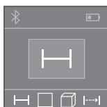
Ob vklopu je merilna naprava samodejno nastavljena na merjenje razdalje. Druge merilne funkcije lahko nastavite z večkratnim pritiskom tipke **2** (glejte „Merilne funkcije“, stran 177). Laserski žarek se vklopi po potrditvi merilne funkcije s tipko za merjenje **4**.
