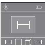
По вклучувањето, мерниот уред се наоѓа во функција на должинско мерење. Другите мерни функции може да ги поставите со притискање на копчето **2** повеќе пати (види „Мерни функции“, страна 149).
