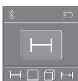
Pēc ieslēgšanas mērinstruments uzsāk darboties garuma mērišanas režīmā. Pāreja citos mērišanas režīmos notiek, atkārtoti nospiežot taustiņu **2** (skatīt sadāļu „Mērišanas veidi” lappusē 218).
