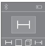
Po włączeniu urządzenia automatycznie ustawia się w funkcji pomiar długości. Pozostałe funkcje pomiarowe można ustawić wciskając parokrotnie przycisk **2** (zob. »Funkcje pomiaru«, str. 13).
