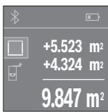
Nyomja meg a **4** mérőgombot, hogy ezzel elindítson egy további felületmérést. Számítsa ki a felületet a „Felületmérés” szakaszban (lásd 56. oldal) leírtak szerint. Az összeadás befejezéséhez nyomja meg a **4** mérőgombot. További mért értékek hozzáadásához nyomja meg még egyszer az **1** [**+**] gombot, stb.
