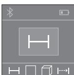
Po zapnutí se měřící přístroj nachází ve funkci měření délky. Další měřicí funkce můžete nastavit vícenásobným stisknutím tlačítka **2** (viz „Měřicí funkce“, strana 27). Po potvrzení měřicí funkce tlačítkem měření **4** se zapne laserový paprsek.
