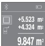
Натисніть на кнопку вимірювання **4**, щоб розпочати нове вимірювання площі. Визначте площу згідно з розділом «Вимірювання площі», див. стор. 89. Щоб завершити додавання, натисніть на кнопку вимірювання **4**. Щоб додати подальші вимірювані значення, натисніть знов на кнопку **1 [+]** і т.д.
