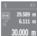
Натиснете еднократно бутона за измерване **4** за насочване към целевата повърхност и още веднъж за измерване.
