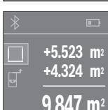
Järgmise pindala mõõtmise alustamiseks vajutage mõõtenupule **4**. Mõõtke pindala vastavalt punktile „Pindala mõõtmine“, vt lk 204. Liitmise lõpetamiseks vajutage mõõtenupule **4**. Järgmiste mõõtetulemuste liitmiseks vajutage uuesti nupule **1 [+]** jne.
