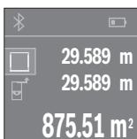
Првата измерена вредност ќе се прикаже горе на екранот. По завршување на второто мерење површината автоматски ќе се пресмета и прикаже. Крајниот резултат стои долу на екранот, а поединечните измерени вредности над него.
