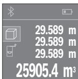
След приключване на третото измерване обемът се изчислява автоматично и се показва на дисплея. Най-отдолу на дисплея стои резултатът, над него – стойностите от отделните измервания.
