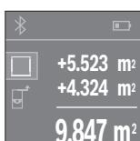
Нажмите на кнопку измерения **4**, чтобы произвести еще одно измерение площади. Определите площадь в соответствии с разделом «Измерение площади», см. стр. 72. Чтобы завершить сложение, нажмите на кнопку измерения **4**. Чтобы прибавлять другие измеренные значения, еще раз нажмите на кнопку **1 [+]** и т.д.
