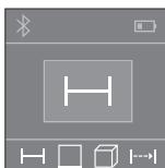
Після увімкнення вимірювальний інструмент знаходитьться в режимі вимірювання довжини. Інші режими вимірювання можна налаштувати багаторазовим натисканням на кнопку **2** (див. «Вимірювальні функції», стор. 88). Після підтвердження режиму вимірювання кнопкою вимірювання **4** лазерний промінь вимикається.
