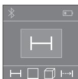
A mérőműszer a bekapcsolás után a hosszmérési funkcióban van. Az egyéb mérési funkciókat a **2** gomb többszöri megnyomásával lehet beállítani (lásd „Mérési funkciók”, a 55. oldalon). A mérési funkcióknak a **4** mérő gombbal való nyugtázása után a lézersugár bekapcsolásra kerül.
