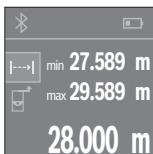
Lai uzsāktu mērījumu, īslaicīgi nospiediet mērišanas taustiņu **4**. Pārvietojiet mērinstrumentu, līdz displeja apakšējā vērtību rindā parādās vēlamā attāluma vērtība.
