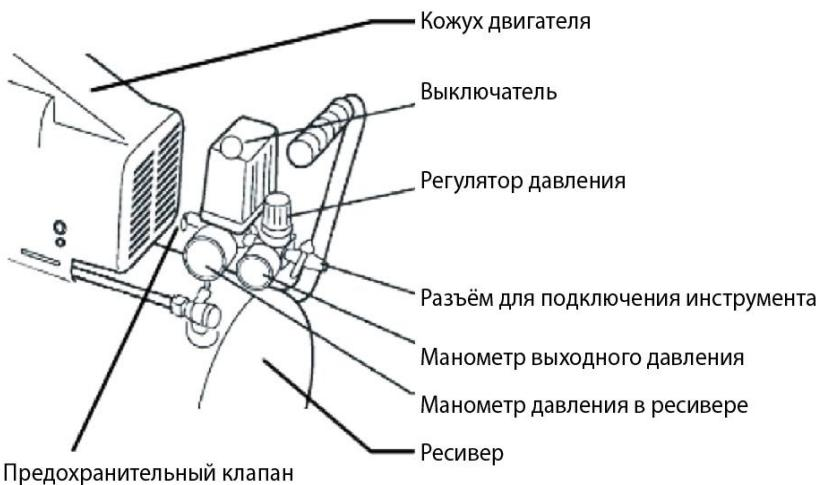
поршня вверх, воздух сжимается и подается в ресивер для накопления. По мере наполнения ресивера сжатым воздухом, давление в ресивере растет. При достижении максимально допустимого давления, автоматика отключит двигатель компрессора. При расходе сжатого воздуха из ресивера (например, для пневмоинструмента), давление в ресивере начинает падать. При достижении нижней установленной границы, автоматика включит двигатель для восполнения использованного воздуха.
