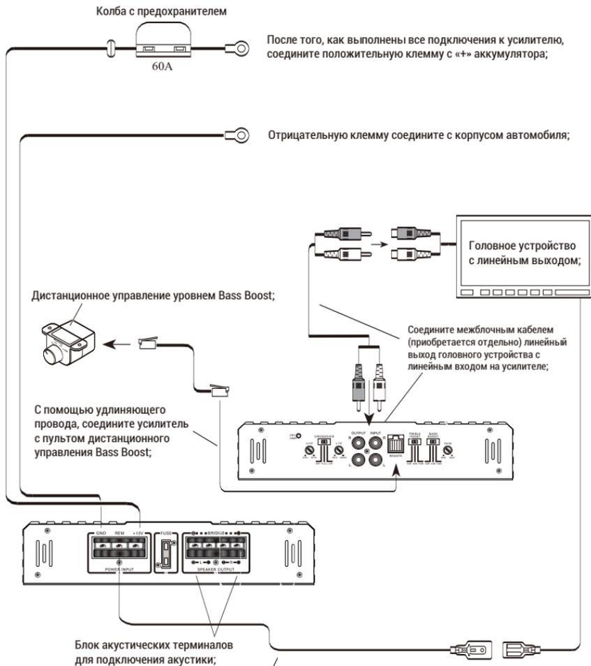
Провод управления включения усилителя. Соедините эту клемму с соответствующим проводом на головном устройстве. Также клемму можно подключить к резистору автомобильной антенны. Еще один метод – подключить провод REMOTE на зажигание автомобиля;
