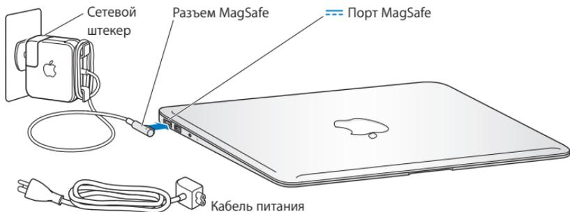
Чтобы расширить зону действия адаптера питания, замените сетевой штекер на прилагаемый кабель питания. Сначала извлеките сетевой штекер из адаптера, а затем подсоедините кабель питания к адаптеру, убедившись, что он надежно зафиксирован. Вставьте другой конец кабеля в розетку питания.
