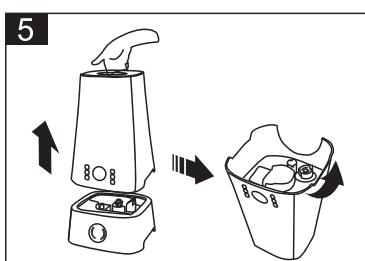
Просуньте руку в отверстие сверху, если необходимо, снимите сначала разбрзгиватель. Второй рукой поддерживайте бак сбоку и потяните вверх. Бак увлажнителя должен отсоединиться. Переверните его и откройте крышку бака.
