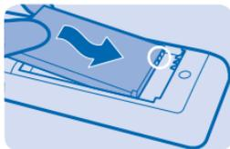
5. Нажмите на заднюю крышку до фиксации.
