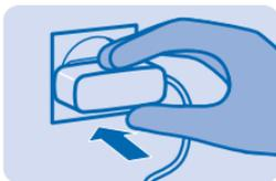
2. Подключите зарядное устройство к телефону. По завершении отключите зарядное устройство от телефона, а затем от сетевой розетки.
