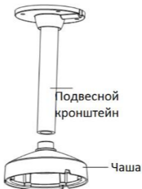
Рисунок 2-24 Установка подвесного кронштейна
